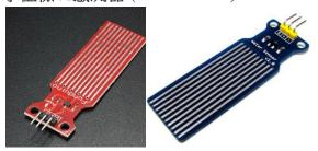
水位感測器是一款簡單易用、性價比較高的水位/水滴識別檢測感測器,其是通過具有一系列的暴露的平行導線線跡測量其水滴/水量大小從而判斷水位。輕鬆完成水量到類比信號的轉換,,達到水位報警的功效。
