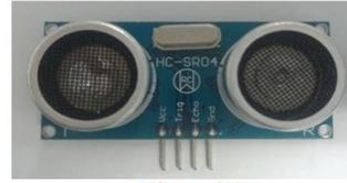
Vcc、 Trig (控制端)、 Echo (接收端)、 Gnd
