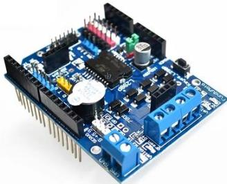
298P Shield 直流電機驅動器採用 LGS 公司優秀大功率電機專用驅動晶片 L298P，可直接驅動 2 個直流電機，驅動電流達 2A，電機輸出端採用 8 只高速肖特基二極體作為保護。疊層設計可直接插接到上，使用更加方便！
